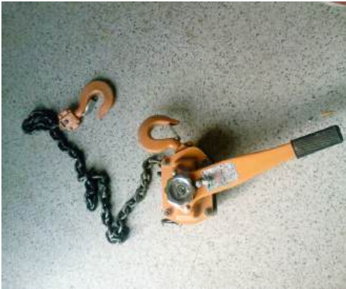
Şekil 10 Çektirme ile ctp boru montajı yapılması
