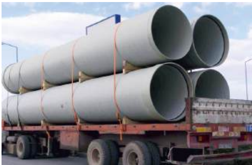
Şekil 4 Sevkiyat esnasında ctp boruların taşınması
